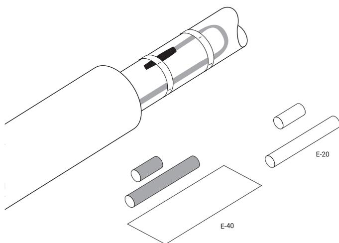
Эти сертифицированные для применения во взрывоопасных зонах термоусаживаемые наборы предназначены для оконцевания под теплоизоляцией саморегулируемых греющих кабелей nVent RAYCHEM.
